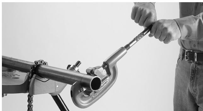
Figure 3 – Coupe de l'extrémité du tuyau
