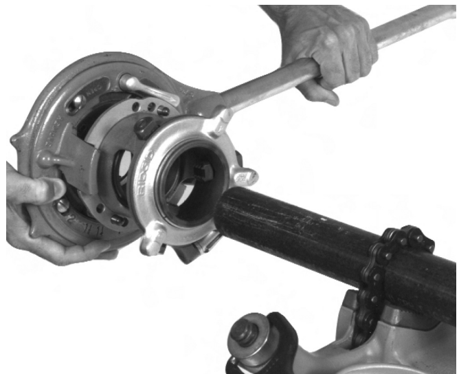
Figure 5 – Montaje de la Roscadora en el tubo
