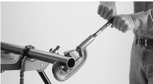
Figure 3 – Corte del extremo de un tubo
