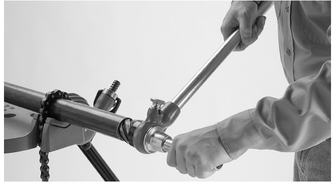
Figure 4 – Escariado del extremo del tubo
