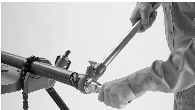
Figure 4 – Alésage de l'extrémité du tuyau
