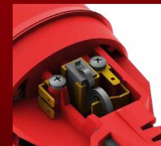
Специальная конструкция щеткодержателя для защиты коллектора при полном износе щеток
